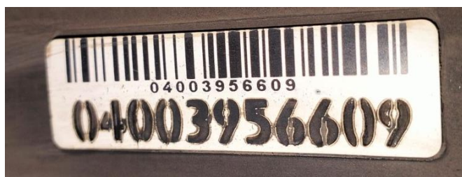
Рис. 1 Пример серийного номера грузовой шины
